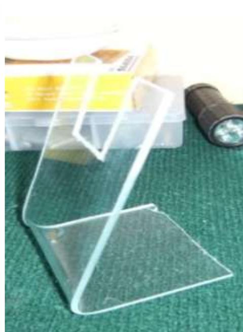
Et voila, tant qui est encore chaud, pendant quelle seconde, (attention cela va très vite) il reste malléable, et on peu encore corrigé sa forme, sinon il faut le réchauffer et ainsi corrigé l'angle et la droiture.
