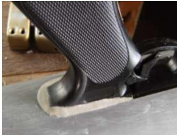
Après toujours avec de la pate à fixe, on bouche les imperfections en modelant le contour de la poignée afin de comblé le décalage et de donner un effet de style.
