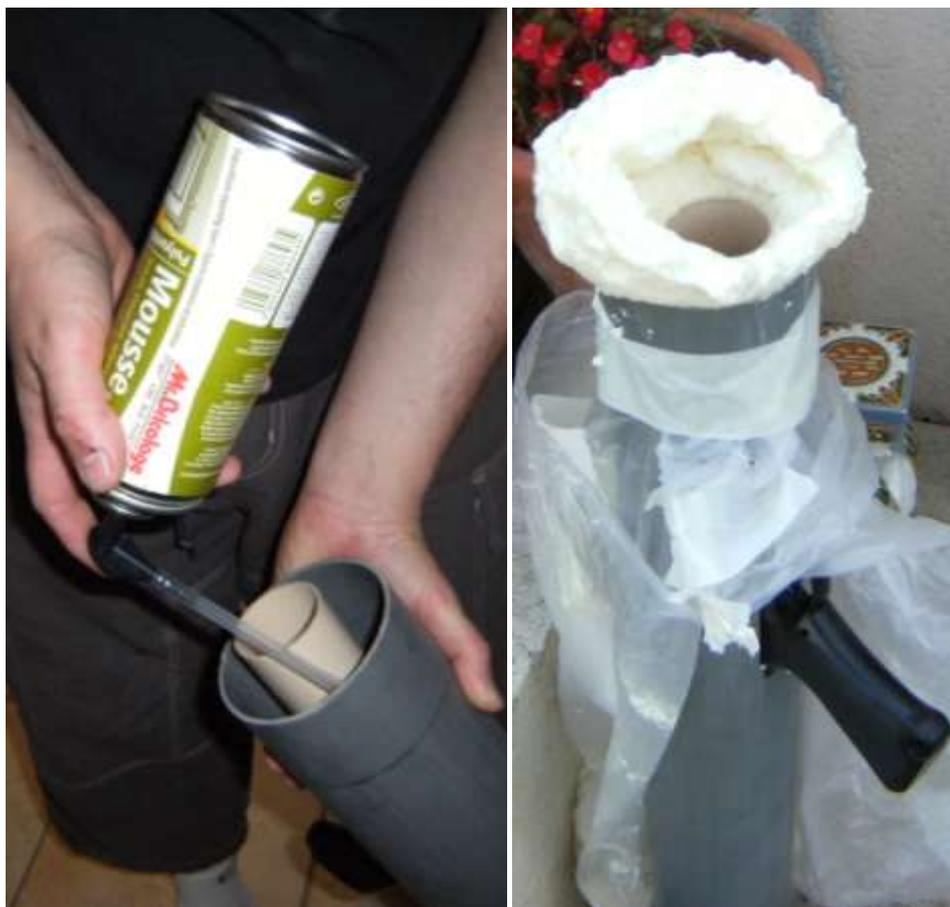
Voilà, une fois la mousse bien prise (laisser la prendre au moins toute la nuit), on enlève le surplus de mousse au cutter, ne pas avoir peur de creuser un peu (1ou2mm), après cela on consolide avec de la pate à fixe en lissant le tout le plus possible pour éviter le ponçage au maximum.
