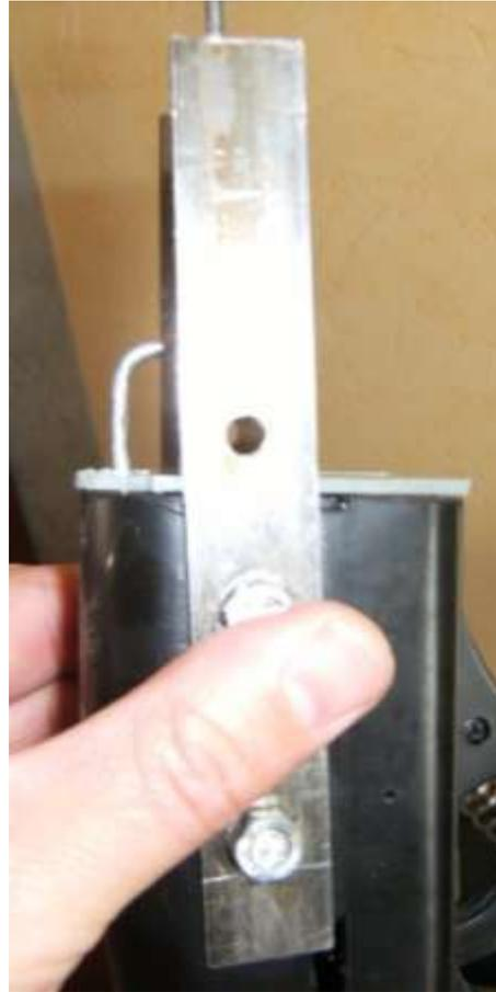
On perce le tube en PVC (toujours de 8), on reporte les trous sur les barres en fer puis on les perce à leurs tours, et comme précédemment on passe une vis pour fixer le tube en PVC à la réplique.
