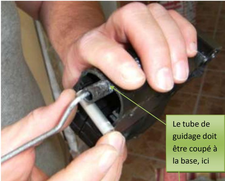
Le tube de guidage doit être coupé à la base, ici
