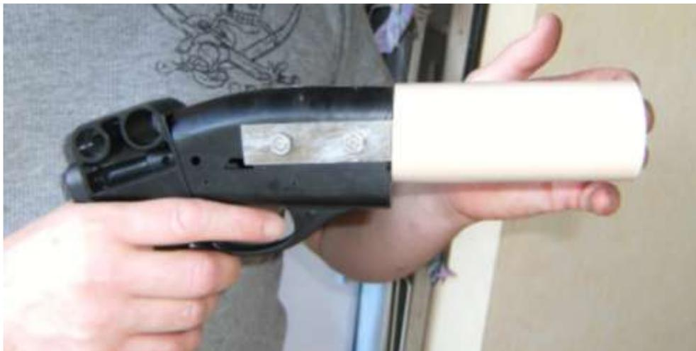
On taille un bout de plexi, qui va servir de guide et de protection du mécanisme.
